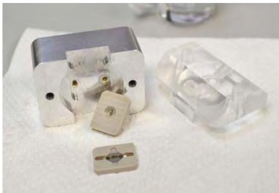
**Figura 1.** Chips y celda de flujo del sensor HFF-QCM
